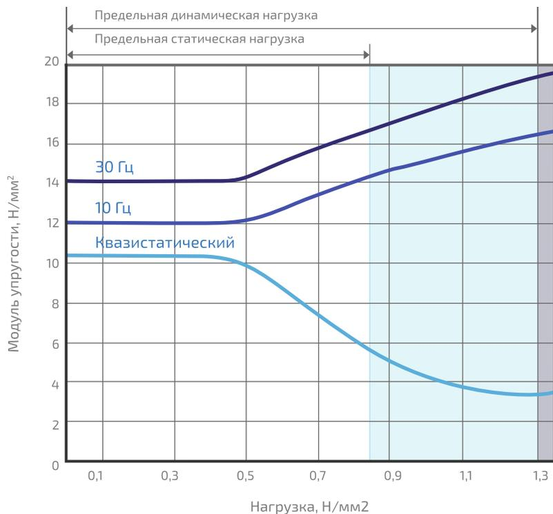
Квастатический модуль упругости рассчитан из данных нагрузка-деформация статических испытаний. Динамический модуль упругости измерен с амплитудой 0.2 мм для 10 Гц и 0.1 мм для 30 Гц. Измерения проведены в соответствии со стандартом DIN 53513.
