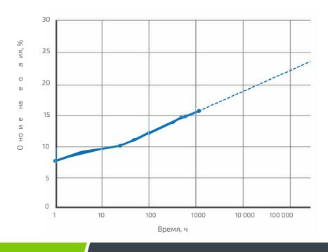
Испытание проведено между двумя плоскопараллельными стальными пластинами. Методика измерения разработана на основе стандарта ГОСТ EN1606-2011. Экстраполяция на 50 лет (438000 ч) данных деформации, полученных в течение 44 суток.
