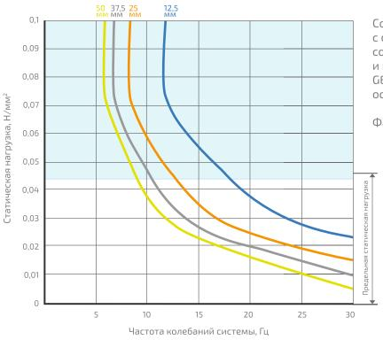
Собственная частота системы с одной степенью свободы, состоящей из массы и виброизолирующего слоя GENER VX 42 на неподвижном основании.
