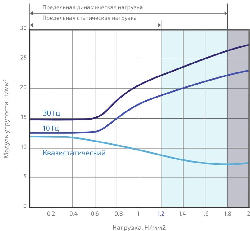
Квасистатический модуль упругости рассчитан из данных нагрузка-деформация статических испытаний. Динамический модуль упругости измерен с амплитудой 0.2 мм для 10 Гц и 0.1 мм для 30 Гц. Измерения проведены в соответствии со стандартом DIN 53513.
