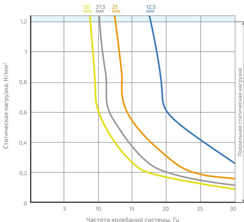
Собственная частота системы с одной степенью свободы, состоящей из массы и виброизолирующего слоя GENER VX 1200 на неподвижном основании.
